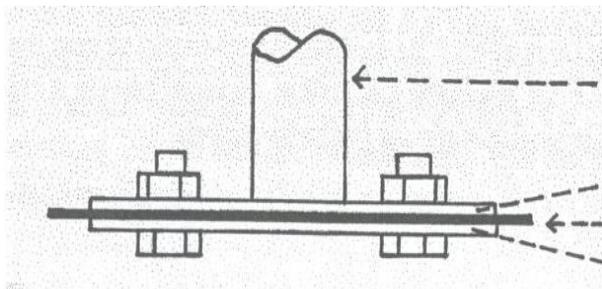
**ÜBERROLLBÜGEL (ROHRSTÄRKE AUSSEN mind. 42 mm, WANDSTÄRKE mind. 2,6 mm)**
